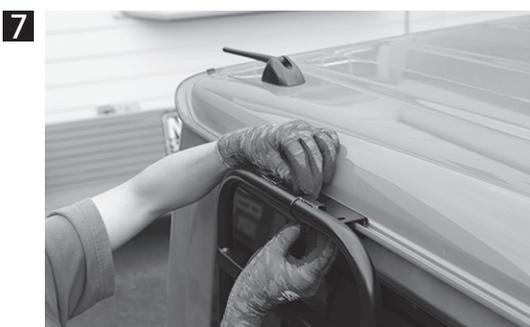
7 本体を取付位置に戻し、車体雨樋を本体とアップブラケットで挟み、3箇所を固定します。
