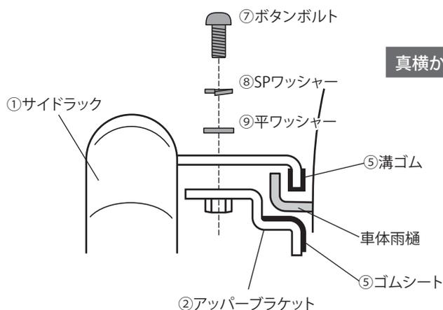
8 ロアブラケットの面テープをしっかり噛ませて、全てのボルトナットを本締めして作業完了です。
