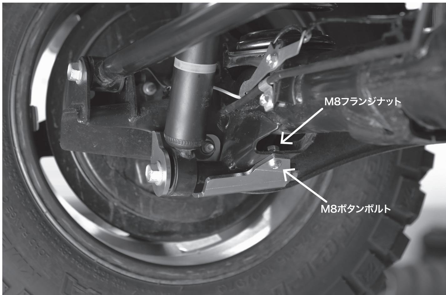
ショックアブソーバー固定ボルト/ナット、トレーディングアーム固定ボルト/ナットと共締めにします。この2箇所のボルトナットは純正品をそのまま使用して下さい。
