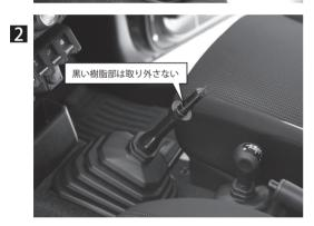
温まったらシフトノブを上方向へ引き抜きます。どの程度温めるかは個体差がありますので「温めては上に引き抜く」を繰り返して下さい。 黒い樹脂部はそのまま使用しますので取り外さないで下さい。
