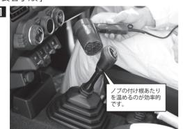
ヒートガン、またはドライヤーで純正シフトノブを温め、樹脂を軟化させます。
