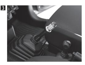
樹脂部に製品付属のスチール製ネジアダプターを被せ、イモネジで合計 5箇所を固定します。
