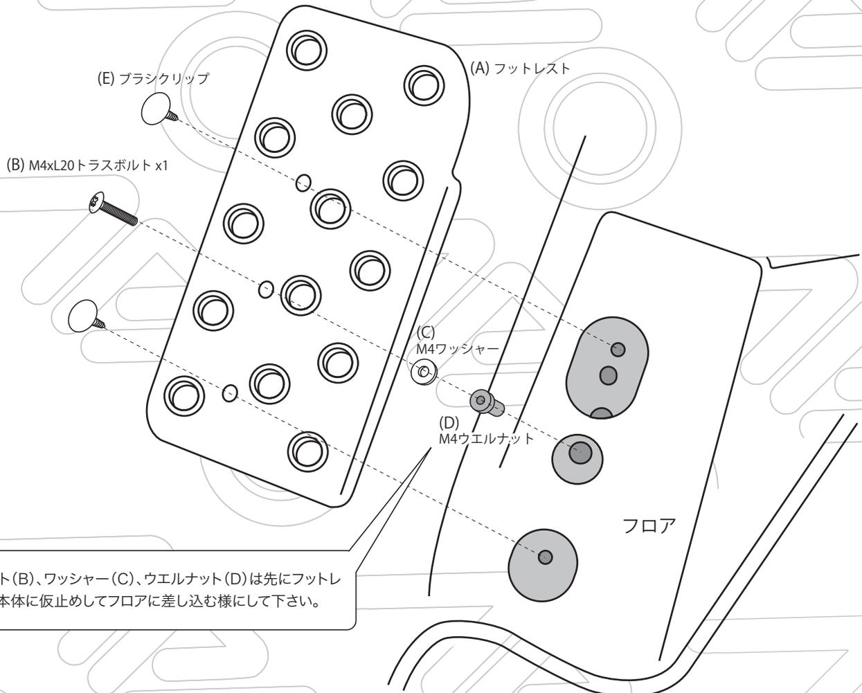
ボルト(B)、ワッシャー(C)、ウエルナット(D)は先にフットレスト本体に仮止めしてフロアに差し込む様にして下さい。
